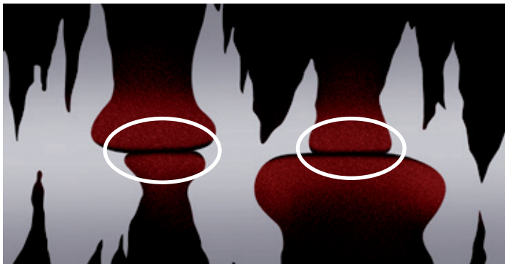
EP-lisäaine – Kun työkalun ja työkappaleen kosketuspinnan lämpötila nousee, lisäaine aktivoituu ja muodostaa suojaavan kemiallisen kalvon, joka estää hitsautumisen.
