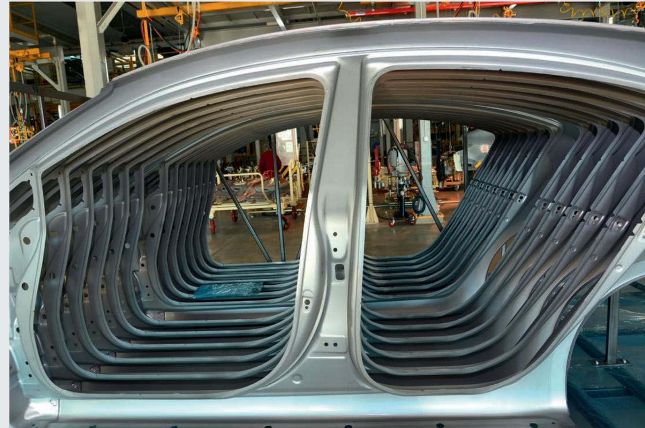
Abgepresste Außenhautteile aus feuerverzinktem Feinblech mit Trenoil ATP
