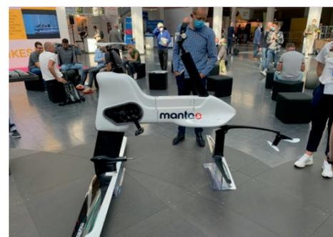
Im Sommer werden Getriebemotoren in diesem elektrisch angetriebenen Board eingesetzt
