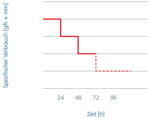
Hinweis: Die erreichbare Mindestmenge ist unmittelbar von den Betriebsbedingungen abhängig. Ein Unterschreiten der Schmiermenge unter das Minimum bedeutet ein erhöhtes Risiko für Flankenverschleiß und Schäden.
