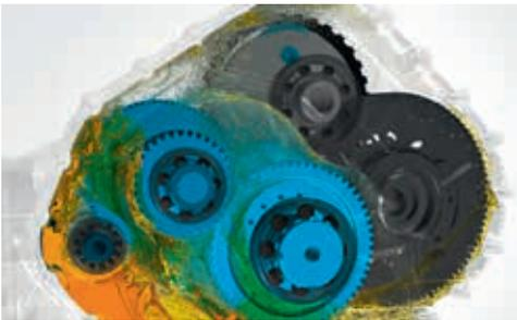
Simulation der Fluidströmung im Hochdrehzahlgetriebe
