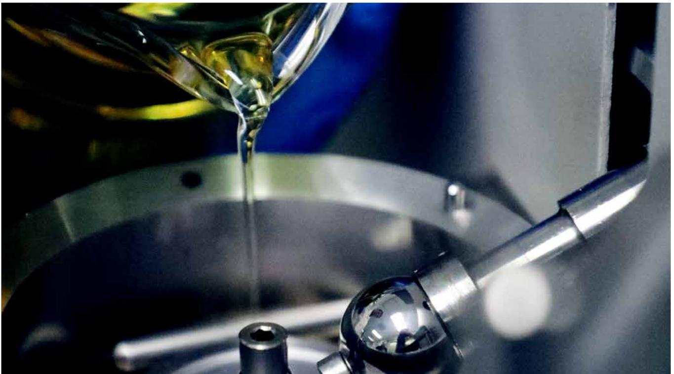
Abbildung 2: Mini Traction Machine
