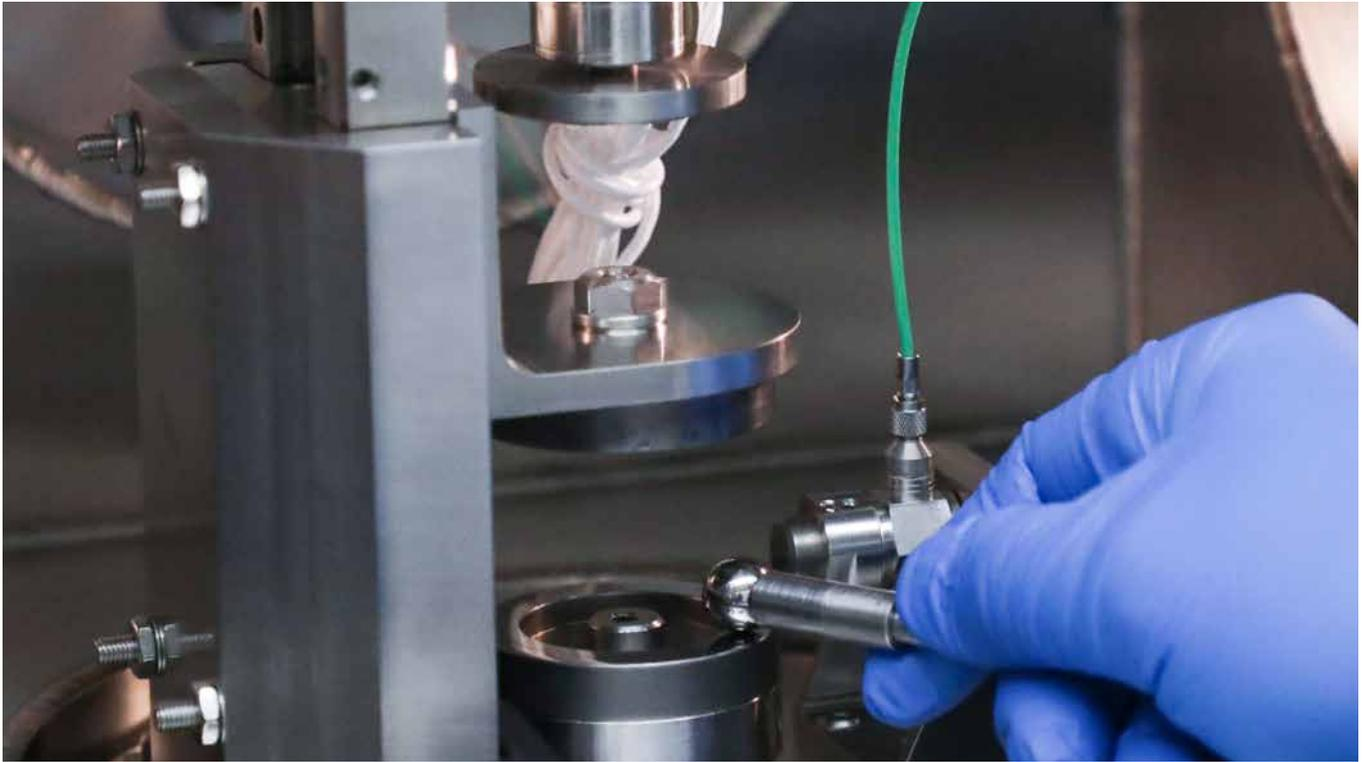
Abbildung 1: Spiral Orbit Tribometer
