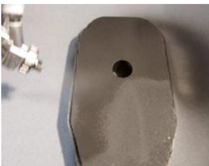
Oberflächenbeschichtung (Sprühen) Linearschieberplatte
