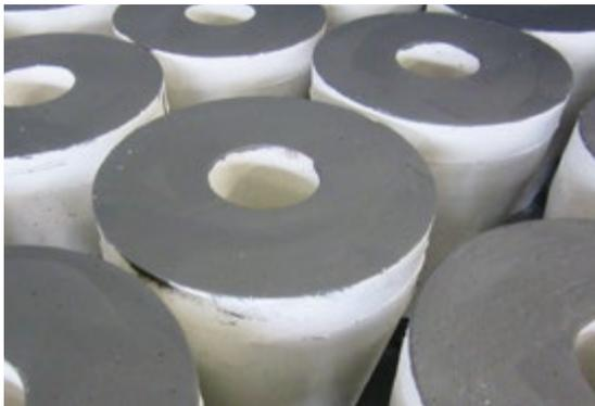
Kaltbeschichtung Dichtfläche keramische Schieberhülse
