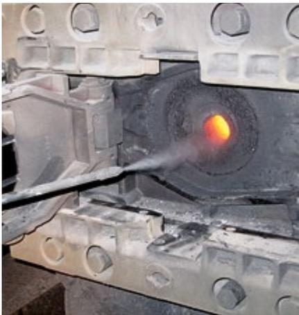
Heißsprühen, Verbindungsfläche eingebaute Schieberhülse/Kopfplatte
