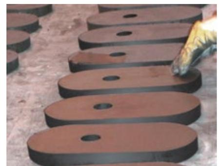
Händische Oberflächenbeschichtung keramischer Schieberplatten
