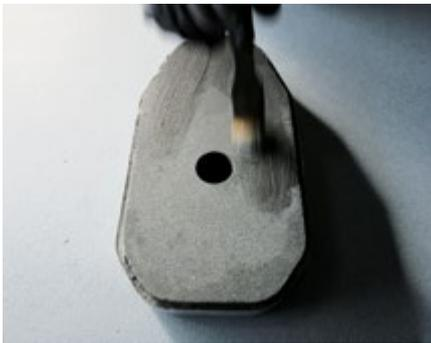
Oberflächenbeschichtung (händisch) keramische Linearschieberplatte
