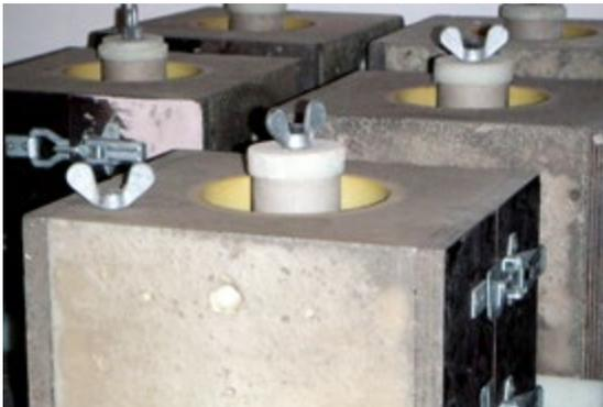
Gießform für die Herstellung gegossener keramischer Bauteile
