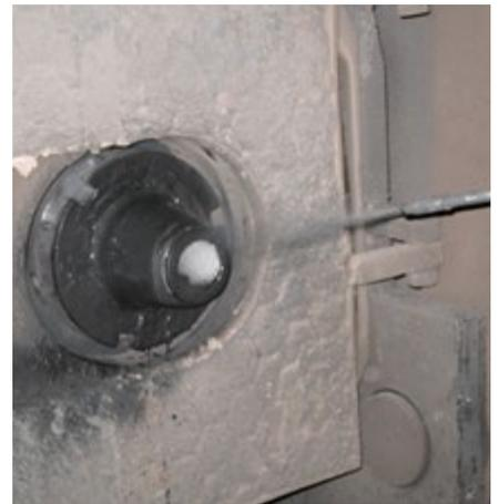
Heißsprühen Auslaufkonus Ausguss (Schattenrohraufnahme)
