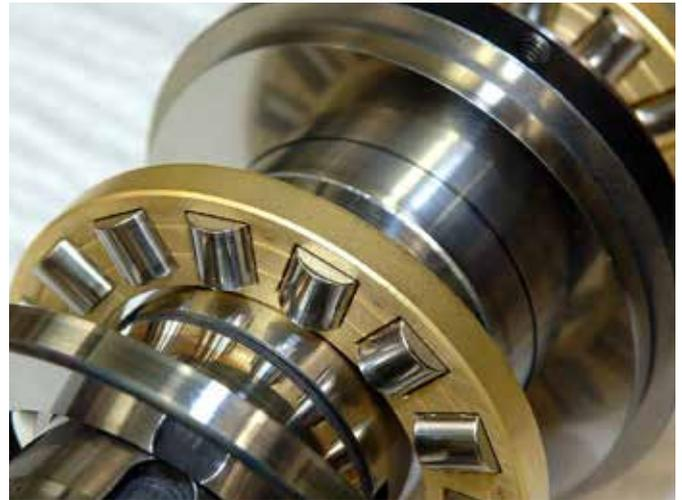
Als High Reference-Öl wurden u.a. RENOLIN UNISYN CLP und RENOLIN UNISYN XT herangezogen. Mit den High Reference-Industriegetriebeölen RENOLIN UNISYN CLP 100 und RENOLIN UNISYN XT 100 wurde eine Laufzeit von >9 Mio. Umdrehungen in diesem Wälzlagertest erreicht, ohne dass es zu Schäden durch WEC gekommen ist.
