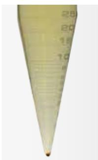
Anschließend werden die Öle im Zentrifugenglas mit Lösemittel verdünnt und somit auf Ablagerungsneigung getestet.
